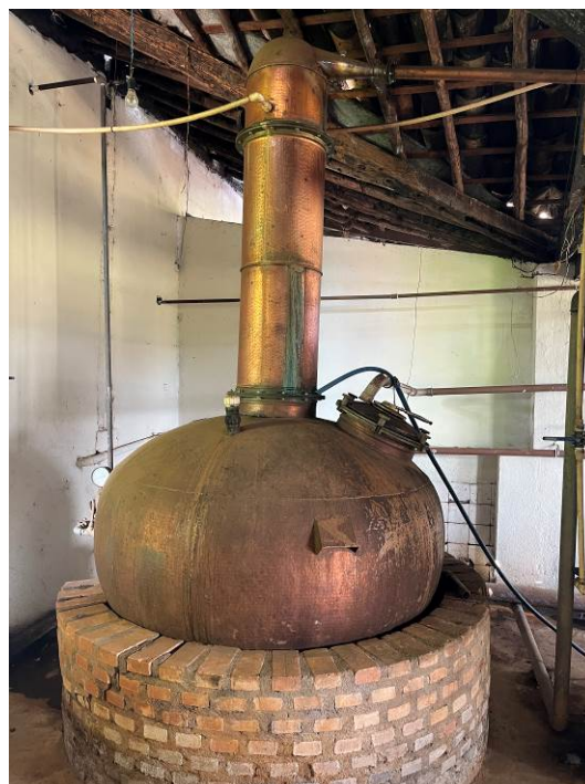
Foto 02: Caldeira do alambique em sua base de alvenaria.
